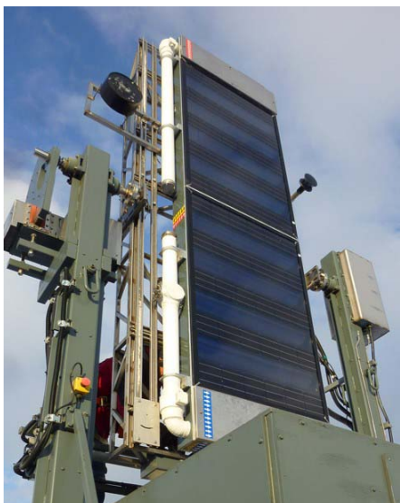
Figure 1 : Prototype d'insolateur PVIBT conçu par KNU dans le centre d'essai PV de CanmetÉNERGIE
