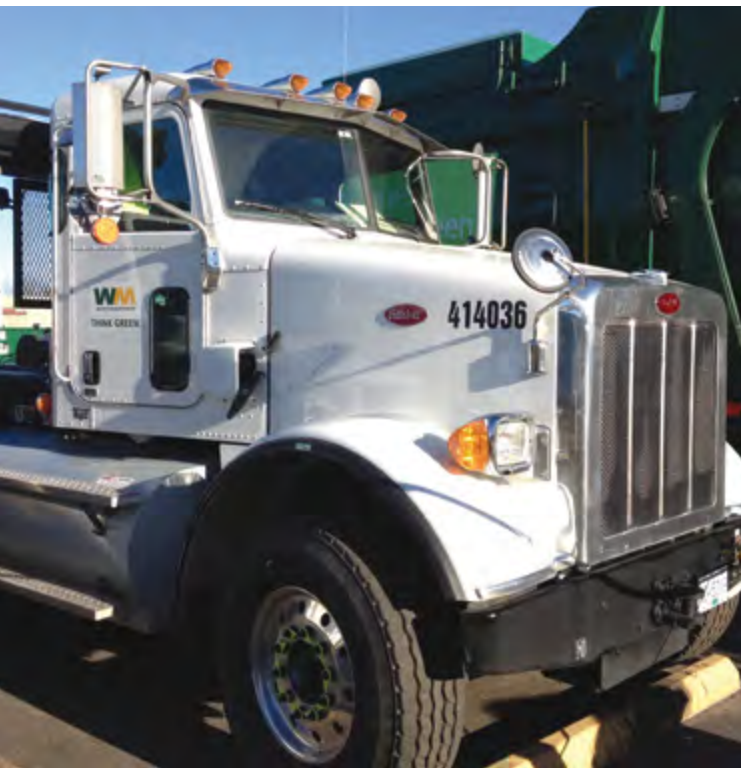
Camion porteur à faux-cadre basculant pour le traitement des déchets avec moteur CWI de 12 litres
