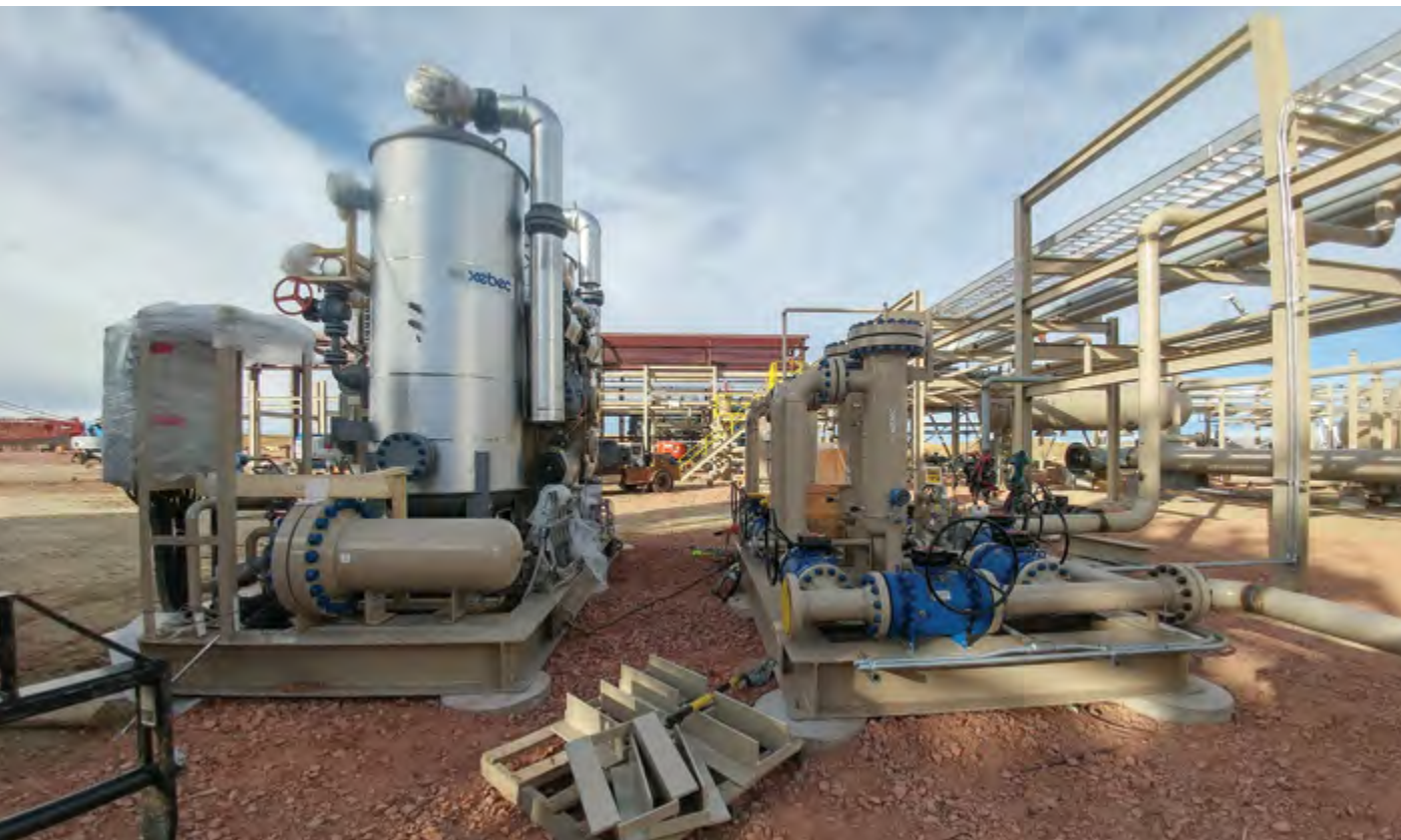
Séchoir au gaz naturel haute pression Xebec de type HRB pour application intermédiaire
