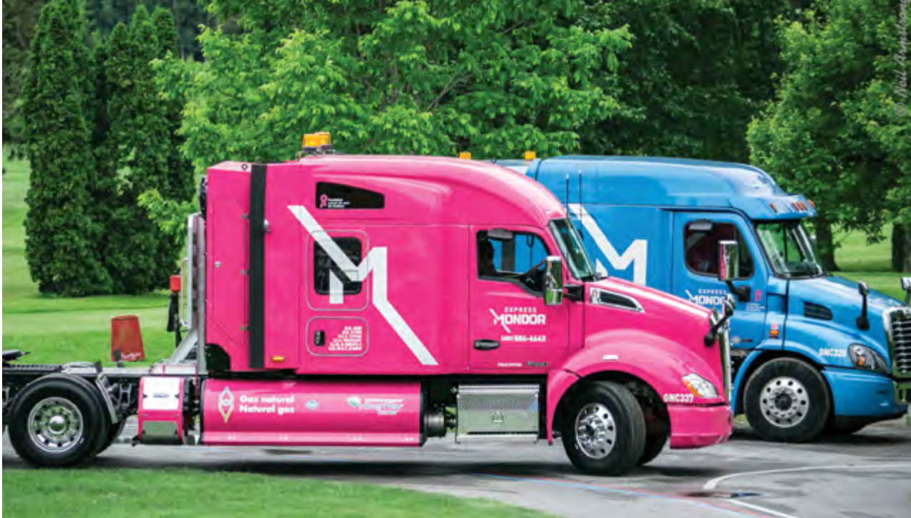
Kenworth T680, moteur Cummins ISX12N, transmission automatique Eaton, réservoir Agility avec capacité de 210 DGE, peint aux couleurs de la Fondation québécoise du cancer du sein
