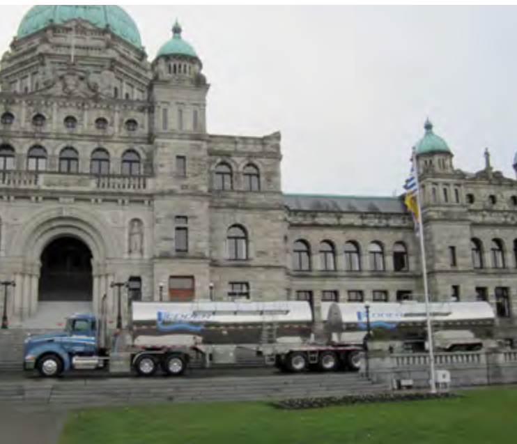
Train Vedder B à la Législature de la Colombie-Britannique de Victoria, C.-B., Peterbilt 386 avec injection directe haute pression, moteur Cummins modifié pour rouler au GNL
