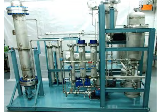
Unité de démonstration de biodiesel montée sur châssis mobile de SBI– avant isolation
